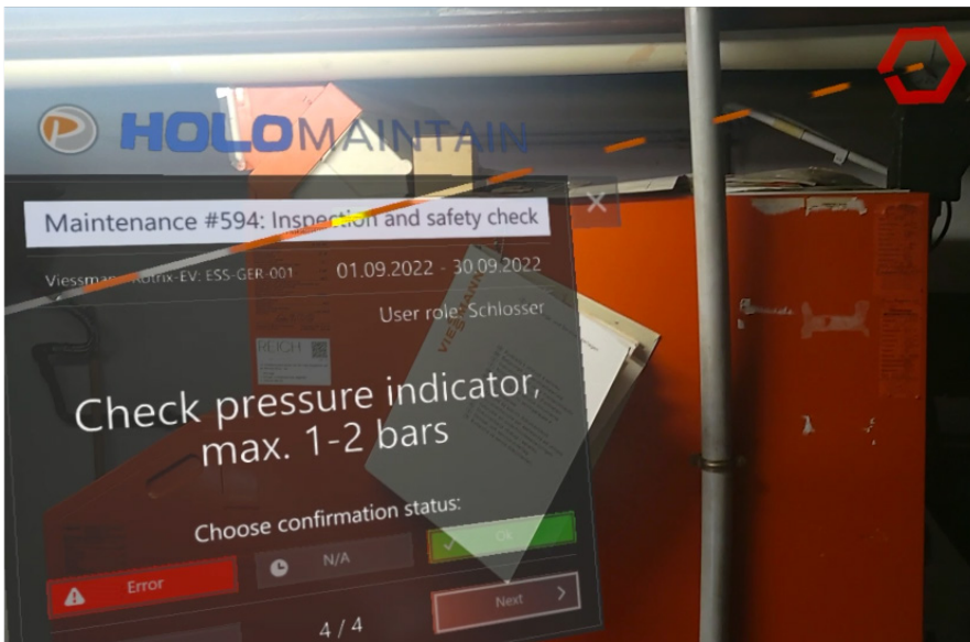
Bild 1: In HoloMaintain führen eingeblendete Dialoge und Wegweiser die Mitarbeitenden schrittweise durch zuvor unbekannte Anlagen und Tätigkeiten.
